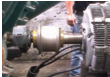
Figure 5-8. Alors que le thermogramme d'un moteur et d'un couplage laisse apparaître des modèles thermiques évocateurs d'un problème d'alignement du couplage des deux côtés, rien ne semble indiquer une telle anomalie sur l'image à la lumière visible.
