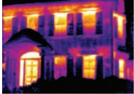
Figure 5-49. Sur cette image, les parties non isolées ressemblent à des zones d'échauffement vues de l'extérieur, par temps froid.
