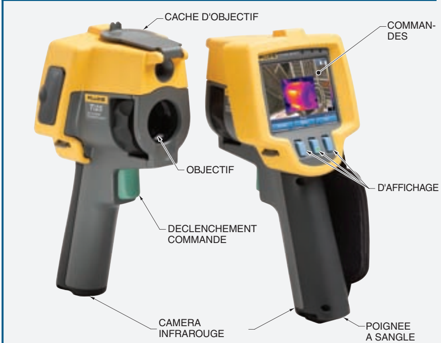
Figure 1-4. De manière générale, les caméras infrarouges sont dotées de plusieurs composants tels que l'objectif, le cache-objectif, l'affichage, les commandes et la poignée à sangle.
