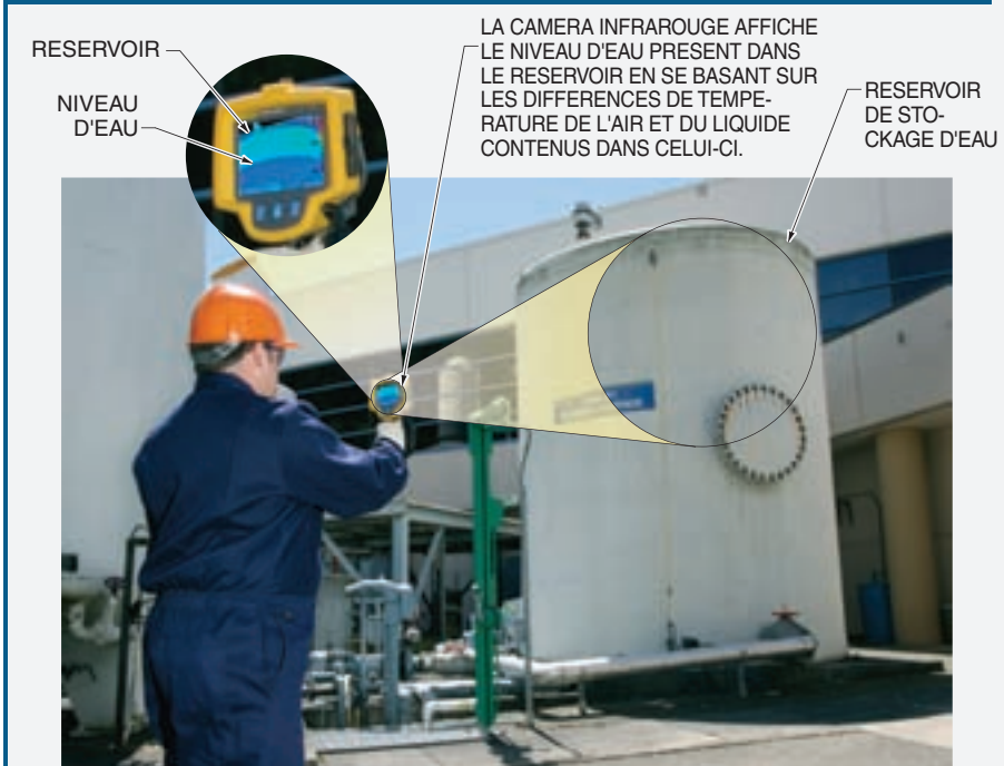
Figure 6-4. La thermographie est communément employée pour la mesure et la confirmation des niveaux de matériaux dans des conteneurs tels que des réservoirs de stockage et des silos.
