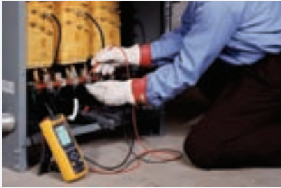
Figure 10-2. L'analyse électrique s'appuie sur un équipement de suivi électrique pour évaluer la qualité de l'alimentation fournie à l'équipement.
