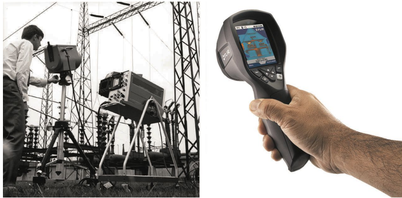
Figure 25.2 À GAUCHE : Thermovision modèle 661 de 1969. La caméra pesait environ 25 kg, l'oscilloscope 20 kg et le trépied 15 kg. L'opérateur a également utilisé un groupe électrogène de 220 V CA et un récipient de 10 l d'azote liquide. A gauche de l'oscilloscope, on distingue le Polaroid (6 kg). A DROITE : FLIR i7 de 2012. Poids : 0,34 kg, batterie comprise.
