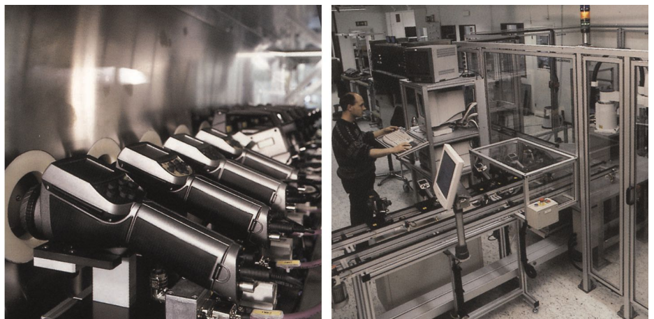
Figure 25.5 GAUCHE : Test de caméras infrarouge en chambre climatique ; DROITE : Robot utilisé pour le test et l'étalonnage des caméras
