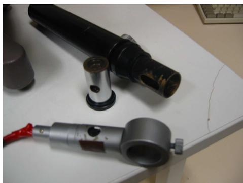
L'oculaire et la monture sont percés. Il faut que les trous soient alignés pour que la lumière atteigne la lame ( non amovible) .
