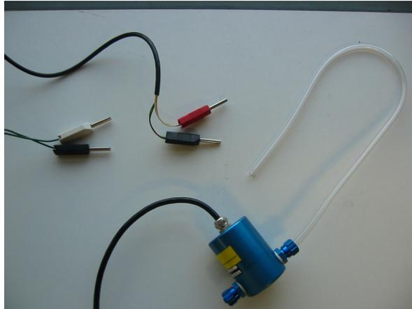
**Le capteur permet de mesurer des pressions différentielles de gaz entre les deux embouts bleus**
